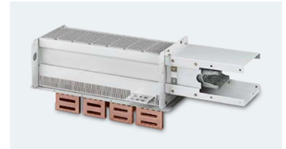
Napájecí díl pro přenos proudu z hlavního transformátoru do trasy LD.
