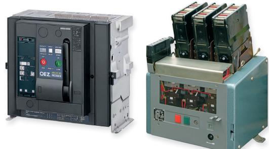
**e.** Jističe BL, BH, BD je možno zprovoznit na dobu nezbytně nutnou jako spínače za použití zaslepovacího bloku odpínače (po odejmutí elektronické spouště) po vycištění od bahna a nečistot, nejlépe oplachem vody a vysušením. Po vysušení je nutno, aby přístroj měl izolační stav minimálně 2 MΩ. Elektronické spouště nelze opravovat. Protože nelze zaručit dlouhodobě spolehlivou funkci jističů po zaplavení, je nutno po odeznění stavu nouze jistič vyměnit za nový.
