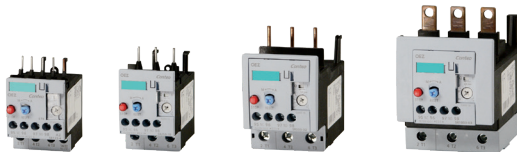
Obr. 2-32: Nadproudová relé SR produktové řady Conteo, typové velikosti SR12, SR25, SR50 a SR100; rozsah jmenovitých proudů I_n = 0,16 \div 100\text{ A}
