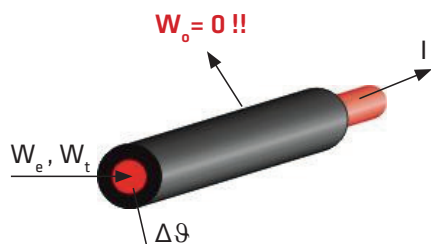
Obr. 4-4: Znázornění poměrů při krátkodobém průchodu proudu vodičem (adiabatický děj)
