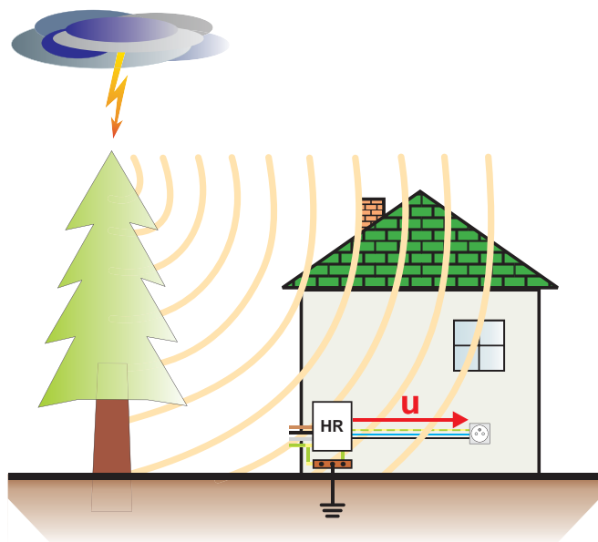
Úder v blízkosti stavby Malé ohrožení instalace
